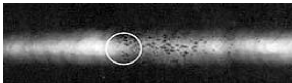
某钢板对接焊缝 X 射线照相底片 V 型坡口，手工电弧焊，密集气孔
