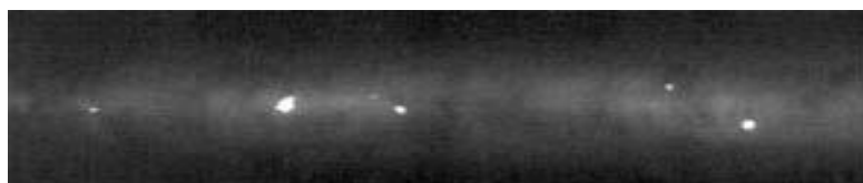
钢板对接焊缝 X 射线照相底片 V 型坡口，钨极氩弧焊打底+手工电弧焊，夹钨
