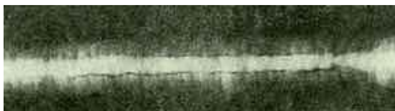
钢板对接焊缝 X 射线照相底片 V 型坡口，手工电弧焊，局部夹渣 和两侧线状夹渣
